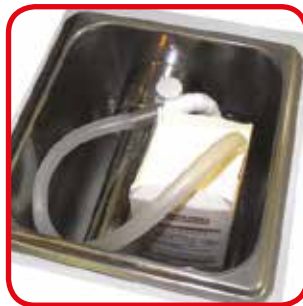
可以将泵直接连在奶油包装上
